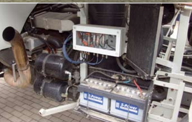
Kraftzentrale: Hinter den Luftkesseln und den beiden Intercoolern verstecken sich die Turbos, im Schaukasten die Sensorik für die Verstellelektronik. Rechts daneben ein weiterer Kühler für die wassergekühlte Dämpfung.
