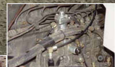
Pump me up: Das ist doch keine Mercedes-Einspritzpumpe! Nein, die am Hellgeth-Mog kommt von MAN und ist natürlich „überarbeitet“. Verstärkt: die Dämpfer-Aufnahmen (li.).
