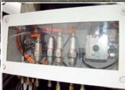
Kraftzentrale: Hinter den Luftkesseln und den beiden Intercoolern verstecken sich die Turbos, im Schaukasten die Sensorik für die Verstellelektronik. Rechts daneben ein weiterer Kühler für die wassergekühlte Dämpfung.
